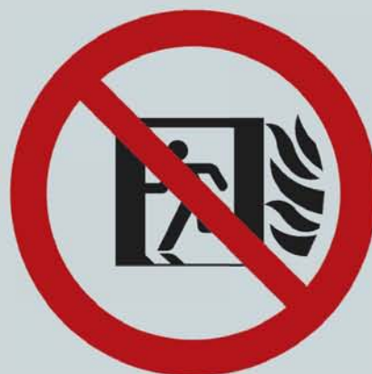
„Spezialkennzeichnung“ für Notausgangstüren, die aufgrund der falschen Aufschlagrichtung im Brandfall keinesfalls zur Entfluchtung von Arbeitnehmern genutzt werden dürfen.
