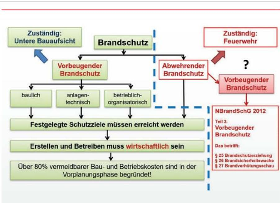
Abb. 4: Brandschutzleitfaden des Bundes, ergänzt um Zuständigkeiten der Feuerwehr
