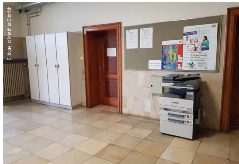
Abb. 4: Der Betrieb elektrischer Geräte innerhalb von notwendigen Fluren wird im Bauordnungsrecht nicht geregelt. Grundsätzlich gilt jedoch, dass mit der Anordnung entsprechender Geräte höchst sparsam umgegangen werden sollte.
