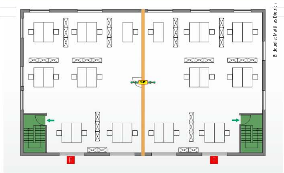
Abb. 2: Die Unterteilung von Nutzungseinheiten mit einer Büro- und Verwaltungsnutzung in Teileinheiten mit einer Fläche von weniger als 400 m 2 setzt voraus, dass jede Teileinheit über ein eigenständiges Rettungswegsystem verfügt.
