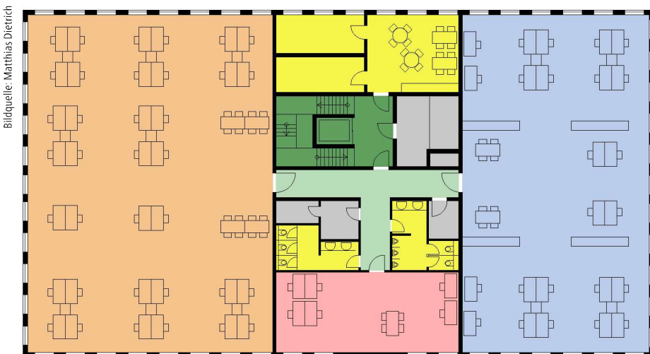
Abb. 7: Exemplarischer Grundriss einer Büronutzung mit getrennten Nutzungseinheiten (orange, rot, blau) sowie gemeinschaftlich genutzten Räumen (gelb)
